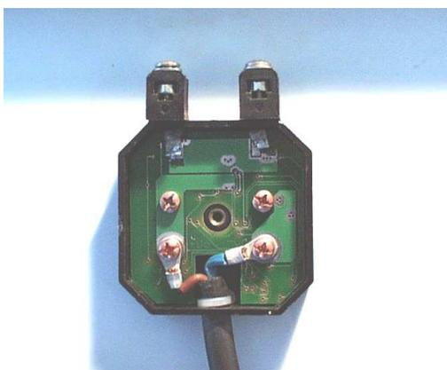
Eine sehr kostengünstige Lösung für einen MPP-Laderegler, ist dessen Integration in die Kabelbox eines Solarmodules, wie es hier geschehen ist. Der von **Schams-Electronic** gelieferte Regler ist in SMD-Technik und misst nicht mehr als 55x55mm bei einer Leistung von 37Wp. Der Vorteil ist nicht nur der einer höheren Leistungsausbeute von bis zu 35% des Solarmodules. Der Kunde wird auch entlastet durch weniger Verdrahtungsaufwand seines Solarsystems.
